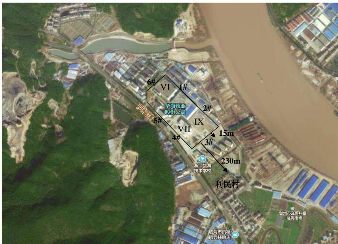
**图 3-1 项目噪声监测点及周边敏感点示意图**
