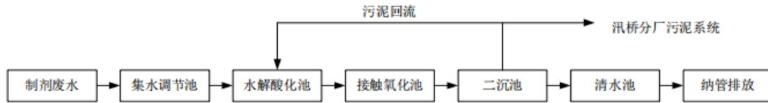
图4.1-3 废水处理工艺流程图
