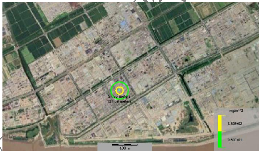
图 6.3.5-7 甲醇储罐火灾影响预测图（最不利气象条件）
