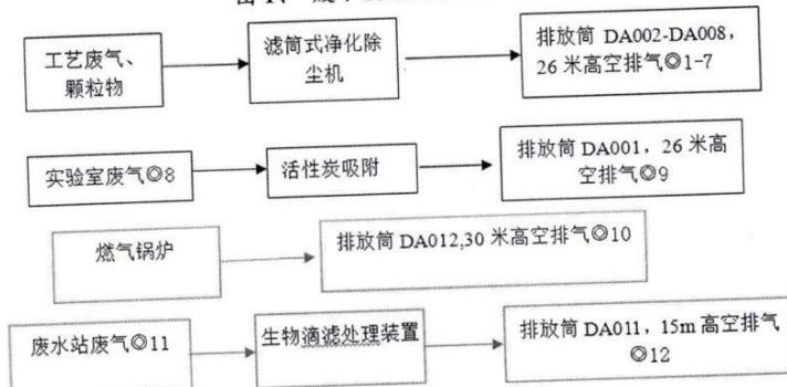
图 2、废气处理工艺及监测点位示意图
